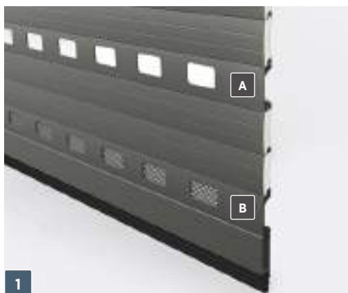
1 Kurtyna bramy – wykonana z profili aluminiowych o wysokości 100 mm i grubości 25 mm wypełnionych bezfreonową pianką poliuretanową. (A) – jednościankowy aluminiowy profil przeszkłony, (B) – jednościankowy aluminiowy profil wentylowany.
