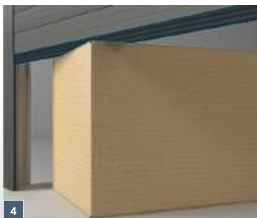
4 Krawędziowa listwa bezpieczeństwa – optyczne czujniki krawędziowej listwy bezpieczeństwa zamontowane są w dolnej uszczelce bramy. Brama po zetknięciu z przeszkodą zatrzymuje się i powraca do pozycji otwartej – standard dla bram Automatik.
