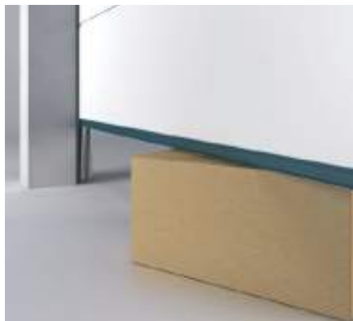
Zabezpieczenie przeciążeniowe w bramie automatycznej
